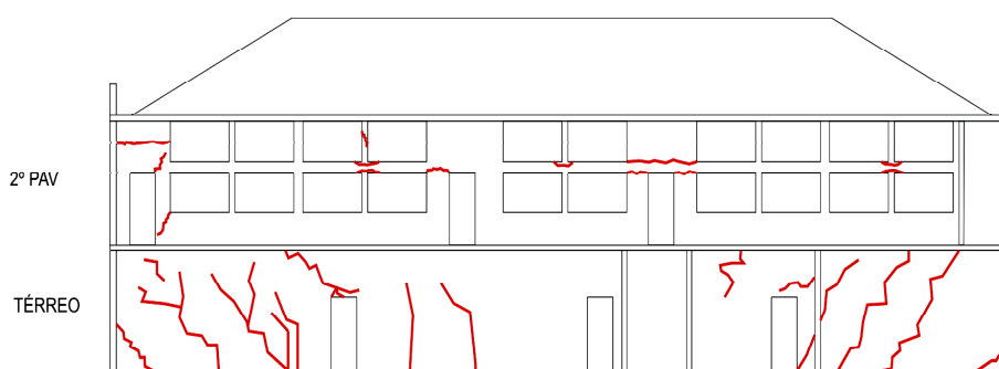
Figura 2.1 – Exemplo de mapeamento de forma e localização de fissuras para utilização em diagnóstico de manifestação patológica (DUARTE & FONSECA, 1997).
