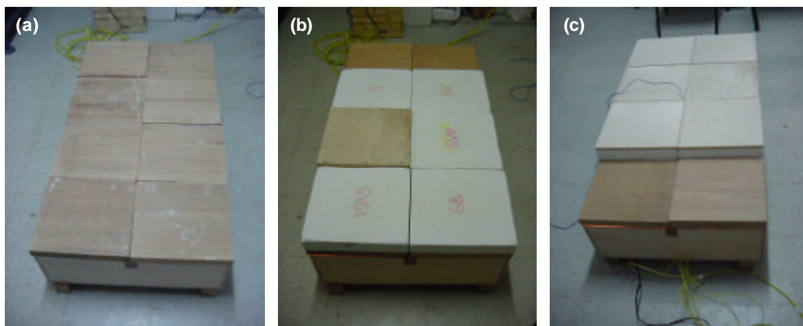
Figura 3 - Seqüência de montagem das amostras sobre a caixa quente. (a) disposição das peças em madeira maciça (Camada 3); (b) disposição do componente central do sanduíche (Camada 2) e (c) disposição das peças de compensado (Camada 1).
